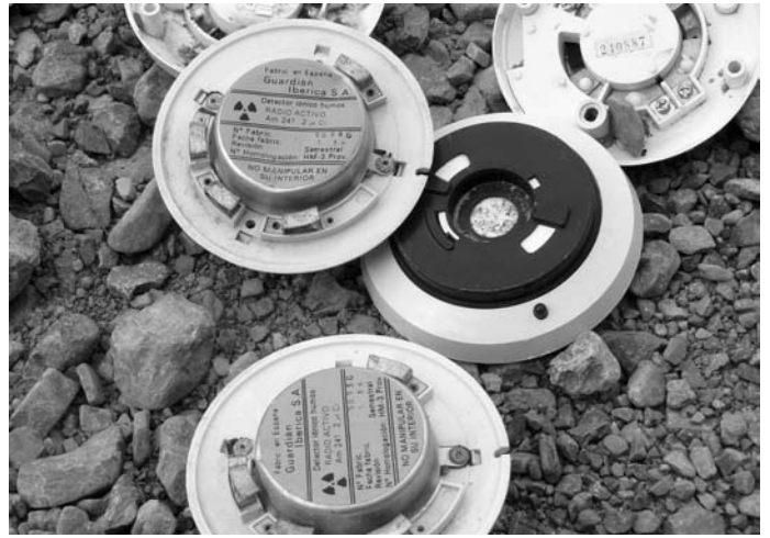
Detectores radioactivos de humos "olvidados" en la inspección del SEPRONA y ENRESA.
